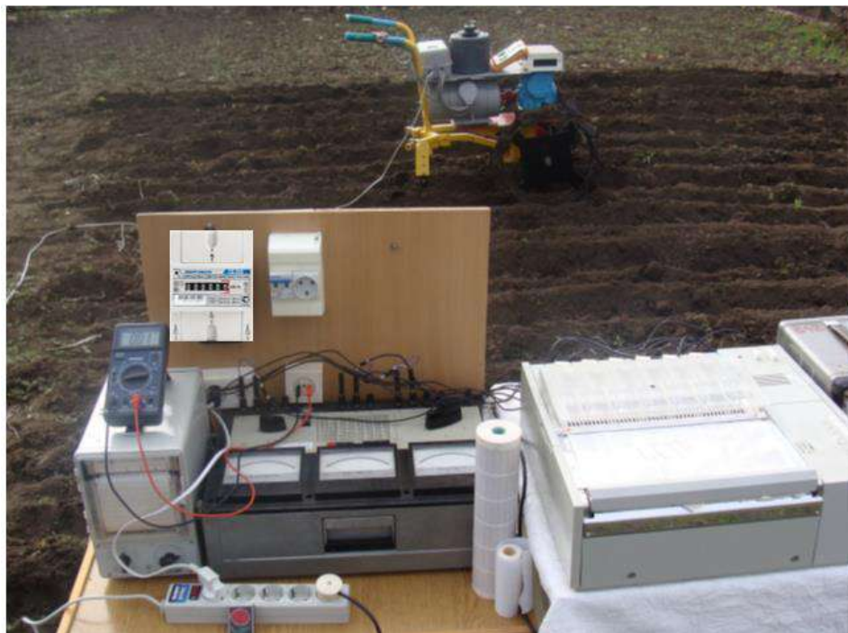
Рисунок 5. Польові випробування електромеханічної системи обробітку ґрунту
