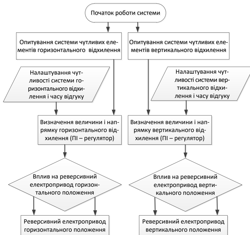
Рисунок 1. Алгоритм регулювання електроприводу орієнтування сонячних панелей
