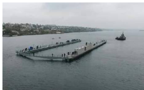
Рисунок 12 – Проведение испытаний испытания композитного автономного плавучего дока "ERENEOS" грузоподъемностью 7100 тонн [7]
