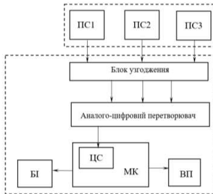
Рисунок 1. Схема структурна реле захисного відключення АД від аварійних режимів роботи
