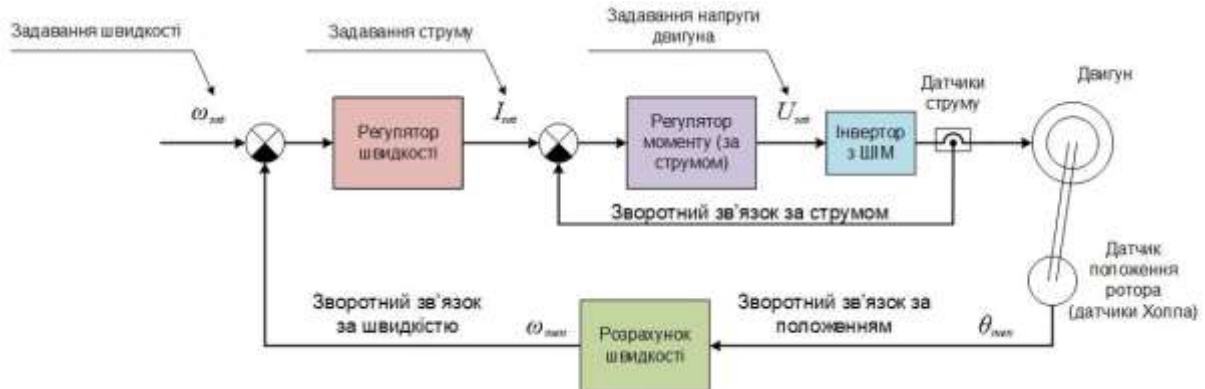
Рисунок 2. Схема керування BLDC-двигуном
