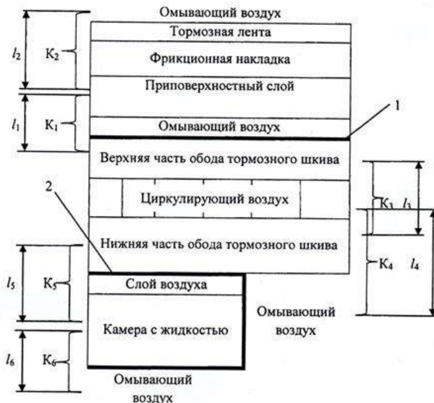
Рис. 3 – Тепловая модель воздушно-жидкостной системы охлаждения фрикционных узлов тормоза: 1, 2 – полированные поверхности обода шкива: рабочая; нерабочая; K_i – коэффициент теплопередачи в теплообменных процессах через многослойные объекты
