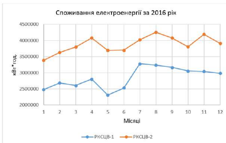
Рисунок 3 – Графіки споживання електроенергії компресорними станціями РКСЦП-1 і РКСЦП-2 за 2016 рік
