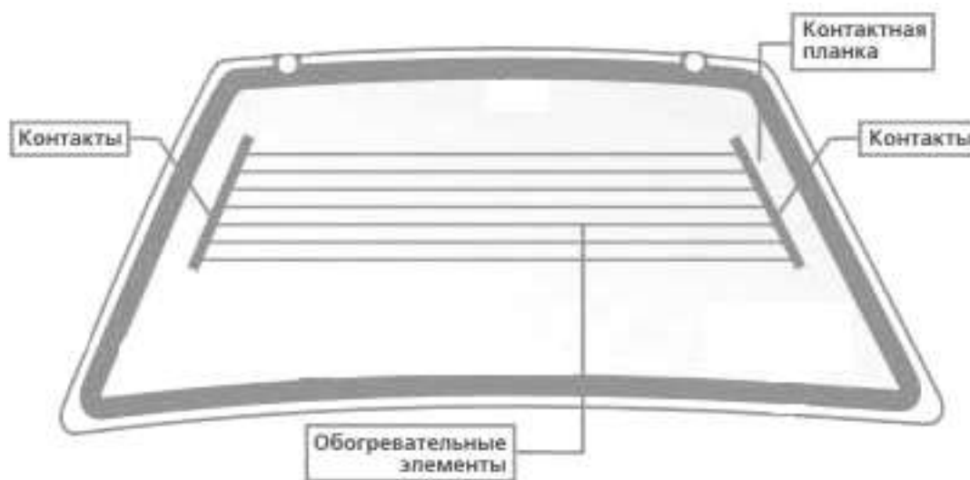
Рисунок 1. Схема обогрева стекла заднего вида с использованием нихромовых нагревателей
