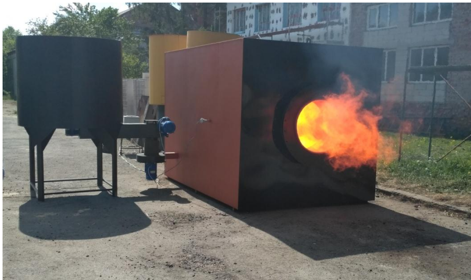
Рис. 1. Пальник твердого біопалива потужністю 3 МВт
