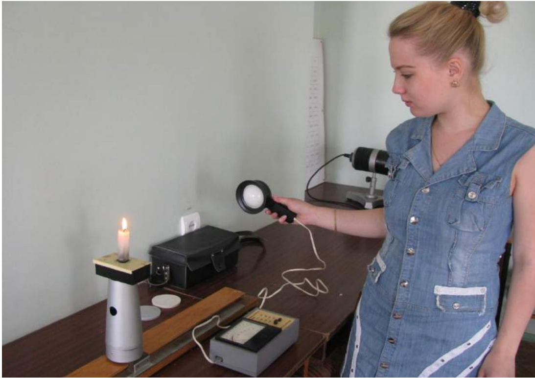
Рис. 3. Визначення сили світла точкових джерел.
