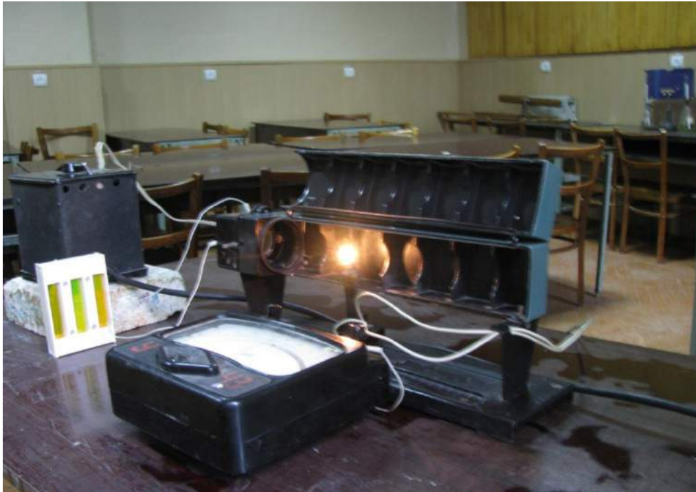
Рис. 1. Типова лабораторна робота по визначенню чутливості фотоелемента
