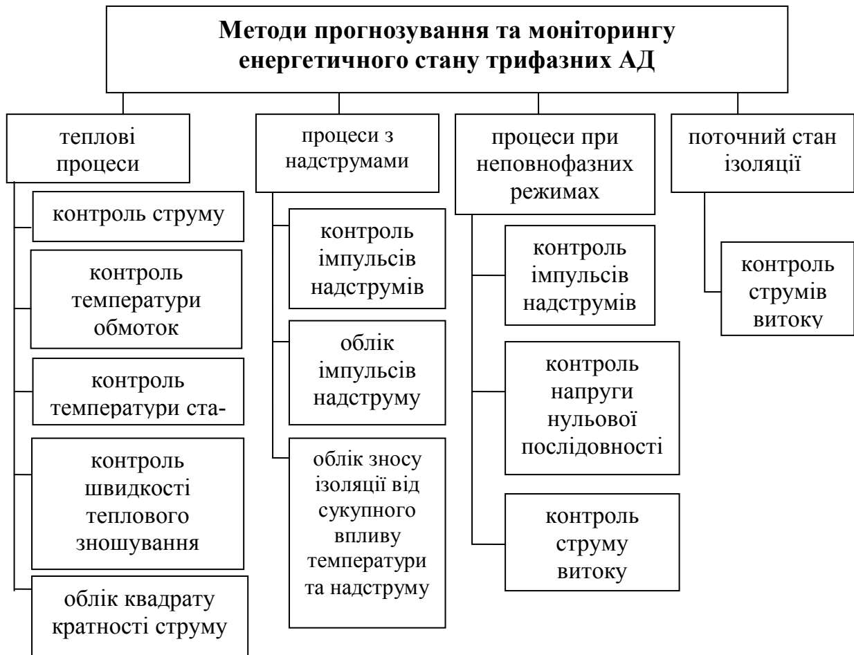
Рисунок 2 - Класифікація методів прогнозування та моніторингу енергетичного стану трифазних АД
