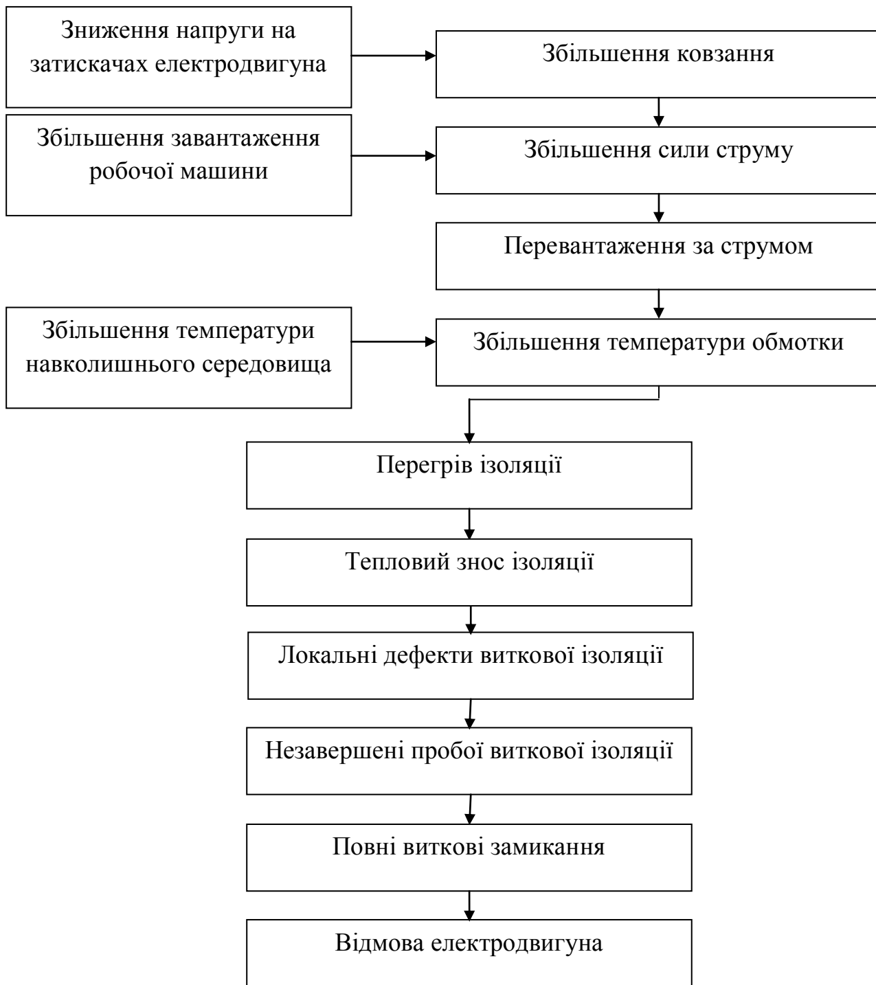
Рисунок 1 – Причинно-наслідковий зв'язок зниження напруги на затискачах асинхронних електродвигунів потокової технологічної лінії
