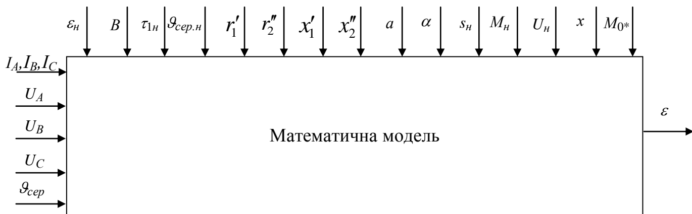
Рисунок 1 – Структурна схема математичної моделі контролю відхилення напруги живлення і захисту асинхронних електродвигунів від неприпустимої витрати ресурсу ізоляції
