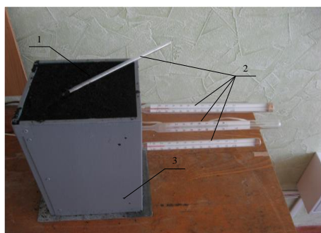
Рис.3 - Загальний вигляд камери для дослідження: 1 - ґрунт; 2 - термометри; 3 - камера для дослідження
