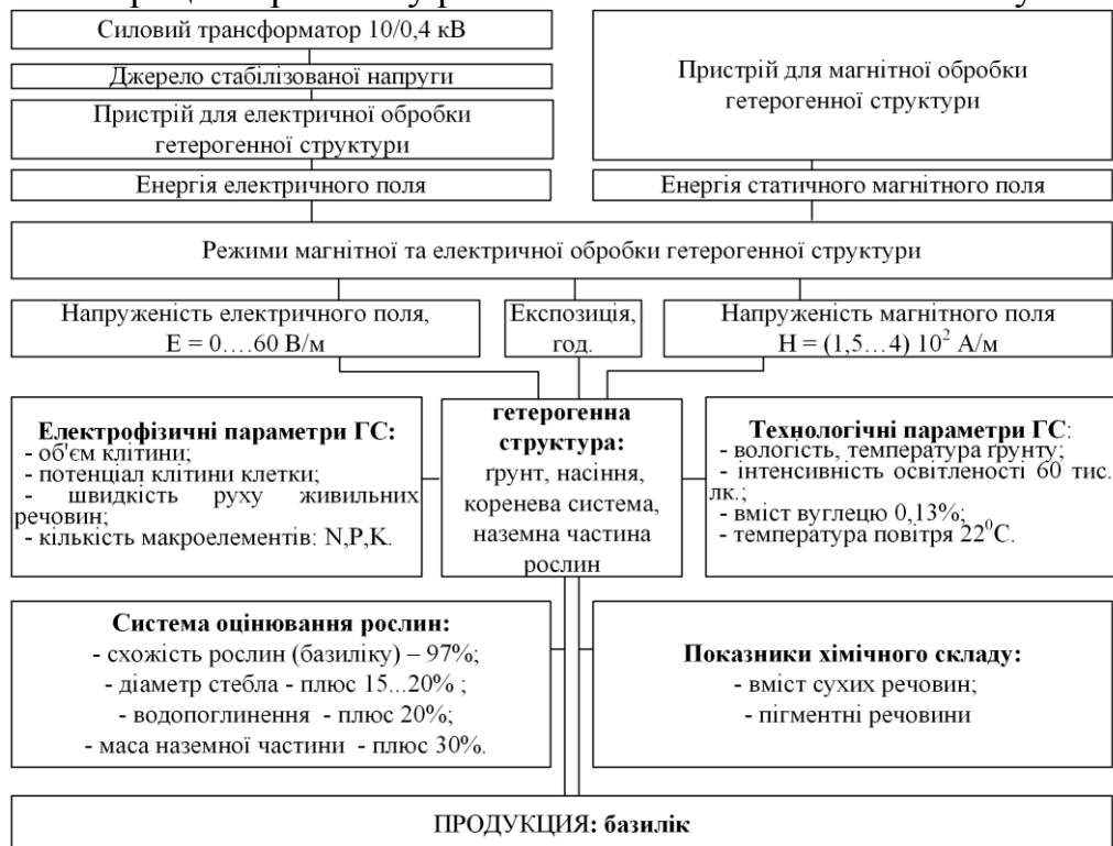
Рис.2. Функційна схема електротехнічної та магнітної систем впливу на процеси розвитку тепличних культур. Дослідження проводились в науково-дослідній лабораторії.
