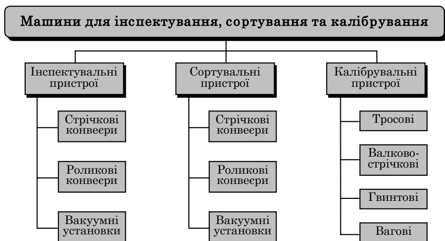
Рис. 1.23. Класифікація машин для інспектування, сортування та калібрування плодовоовочевої сировини
