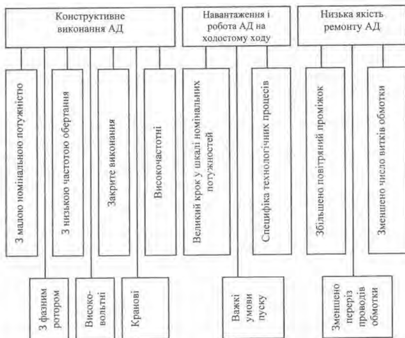
Рис. 17.8. Причини підвищеного споживання реактивної потужності асинхронними двигунами
