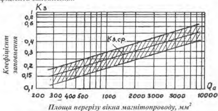
Рис. 15.2. Графіки для визначення коефіцієнта заповнення вікна
