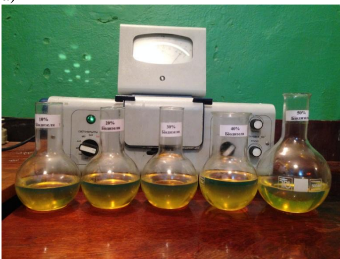
Рис. 2. Експериментальна лабораторна установка: а) фотокалориметр з приготовленими пробами, б) водяний термостат УН-8 з віскозиметром ВПЖ- 4
