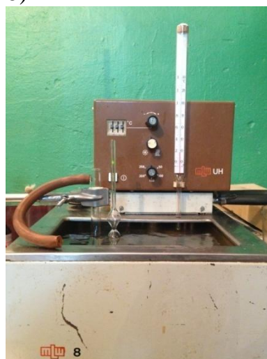
Рис. 2. Експериментальна лабораторна установка: а) фотокалориметр з приготовленими пробами, б) водяний термостат УН-8 з віскозиметром ВПЖ- 4
