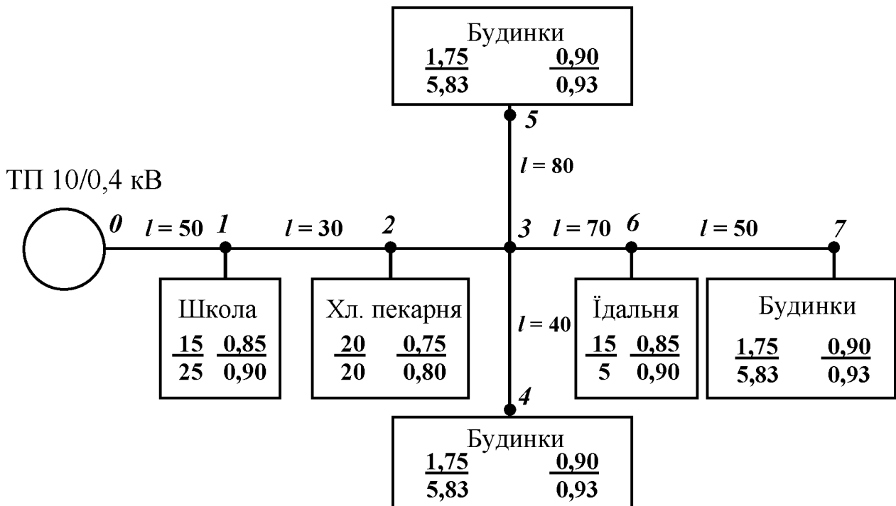
Рисунок 3.1 – Розрахункова схема повітряної лінії 0,38 кВ
