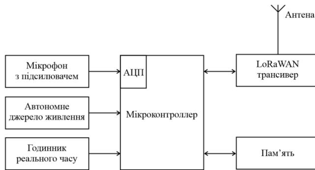
Рис. 1. Структурна схема пристроя акустичного моніторингу
