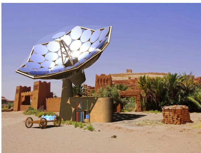
Рисунок 2 - Вироблення прісної води, за допомогою системи сонячної батареї
