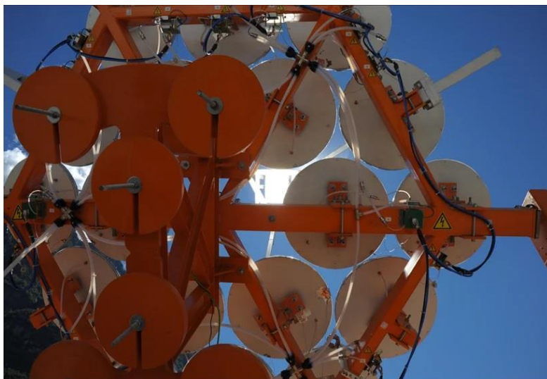
Рисунок 1- Дзеркальна поверхня, яка концентрує сонячне світло
