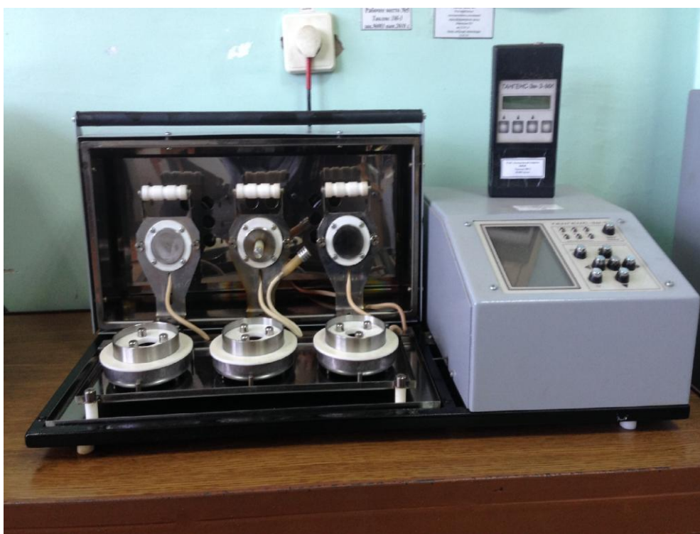
Рисунок 4 - Загальний вигляд установки для вимірювання діелектричних втрат рідких діелектриків «Тангенс – 3М-3»
