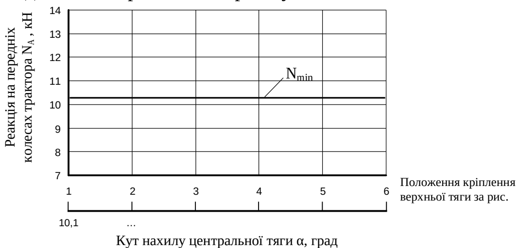
Рисунок 5 – Вплив кута \alpha нахилу центральної тяги заднього навісного механізму трактора на вертикальну реакцію N_A на його передніх колесах
