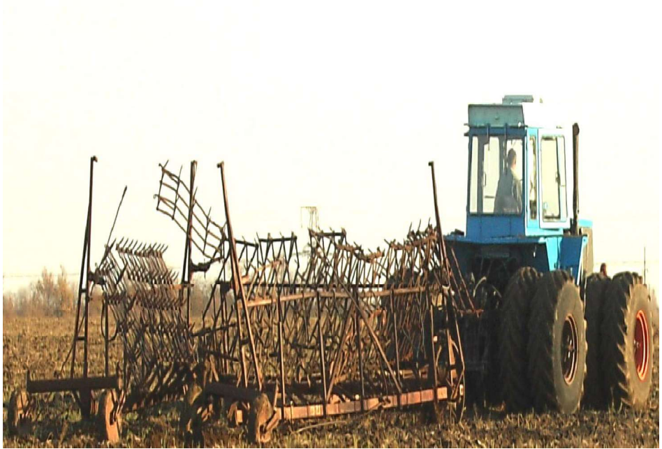
Рис. 17 – Боронувальний МТА на основі ХТЗ-160 зі здвосними шинами 23,1R26 та зчепу СГ-21
