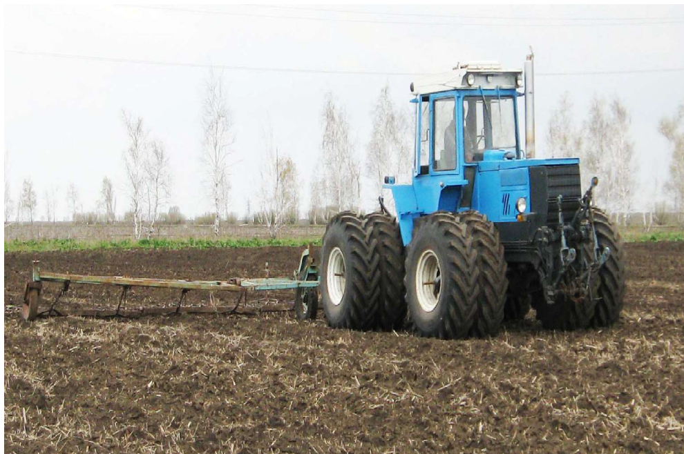
Рис. 18 – Боронувальний МТА на основі ХТЗ-160 зі здвоєними шинами 23,1R26 та зчепу СП-16
