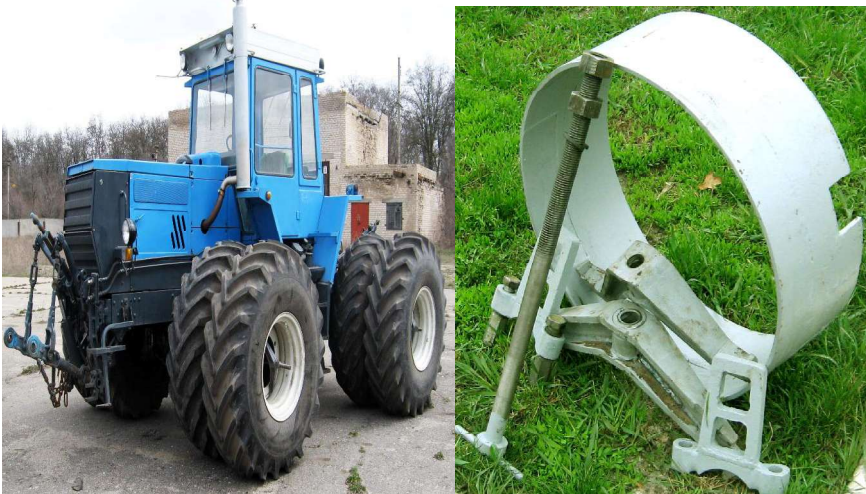
Рис. 16 – Обладнання орно-просапного трактора серії ХТЗ-160 здвоєними шинами типорозміру 23,1R26
