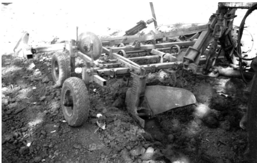
Рис. 5. Переднє навісне знаряддя для прокладання слідів ПТК
