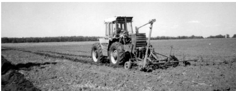
Рис. 6. МТА на базі ХТЗ-160 для прокладання слідів ПТК
