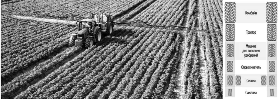
Рис. 2. Рух агрегату та узгодження колій та рушіїв енергозасобів та машин в колійному землеробстві
