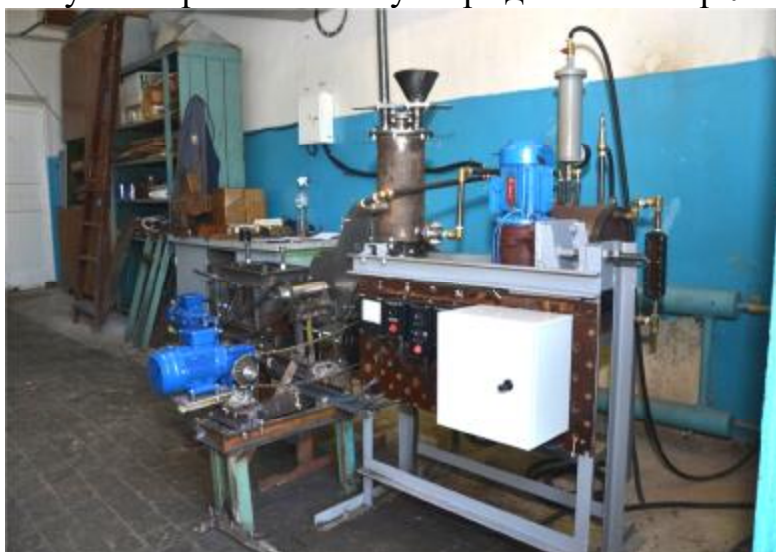
Макет установки для переробки рицини
