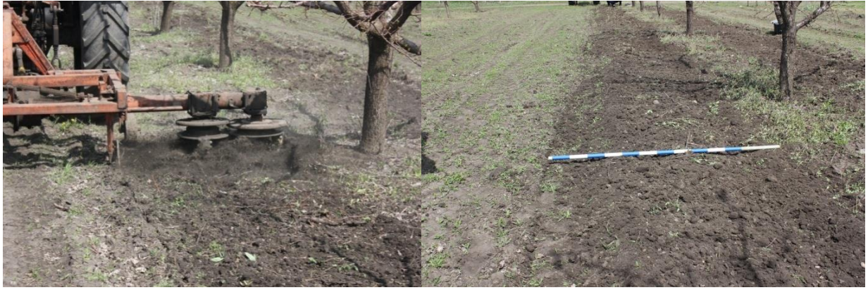
Рис.10. Обробіток ґрунту в пристовбурній смузі фрези МФ-1М з експериментальними робочими органами.
