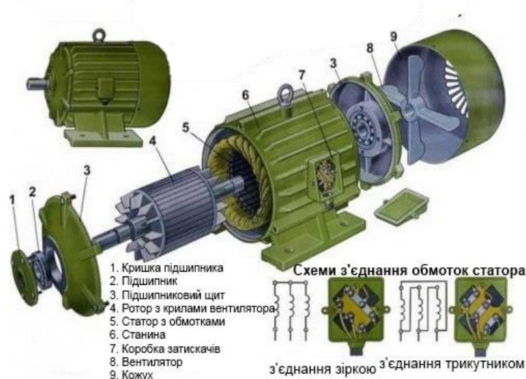
Рисунок 2 – Будова асинхронного електродвигуна [3]
