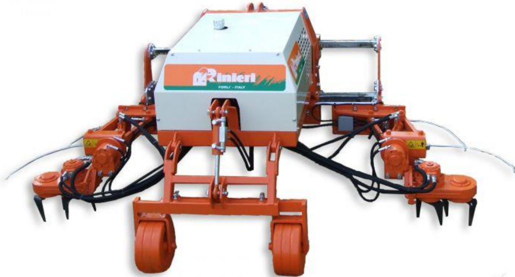
Рис.1.20. Загальний вигляд фрези E-DUE італійської фірми «RINIERI».
