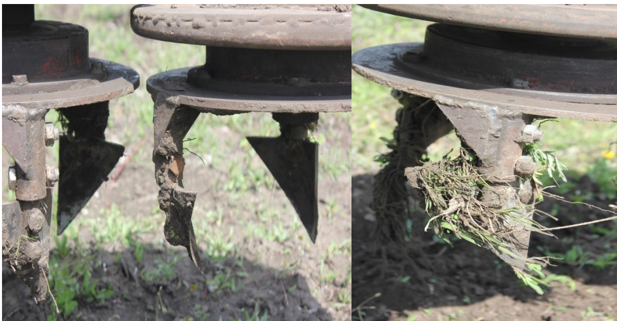
Рис.4.6. Забивання рослинними рештками і злипання ґрунтом робочих органів.
