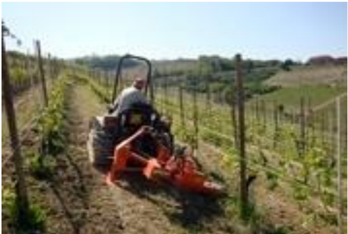
Рис.1.16. Фреза EL італійської фірми «RINIERI» обробляє пристовбурні смуги в плодovих насадженнях.
