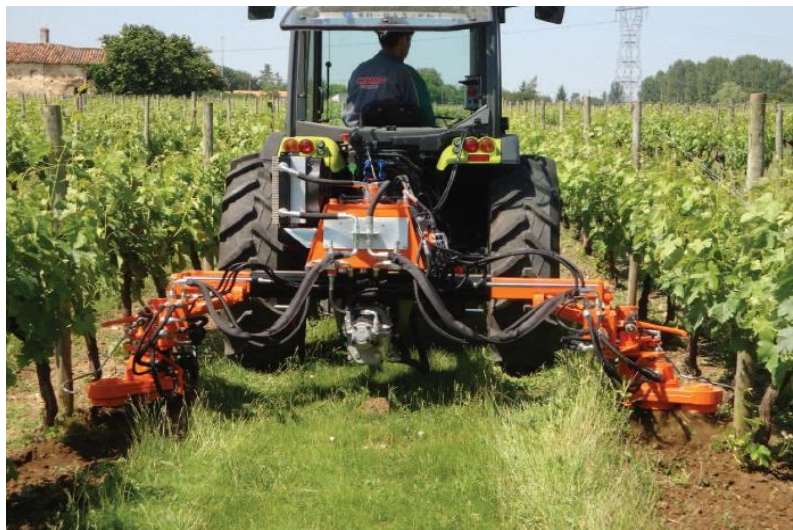
Рис.1.27. Фреза VELOX 8 обробляє пристовбурні смуги виноградників.
