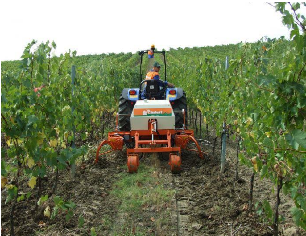
Рис.1.21. Фреза E-DUE італійської фірми «RINIERI» обробляє пристовбурні смуги виноградників.
