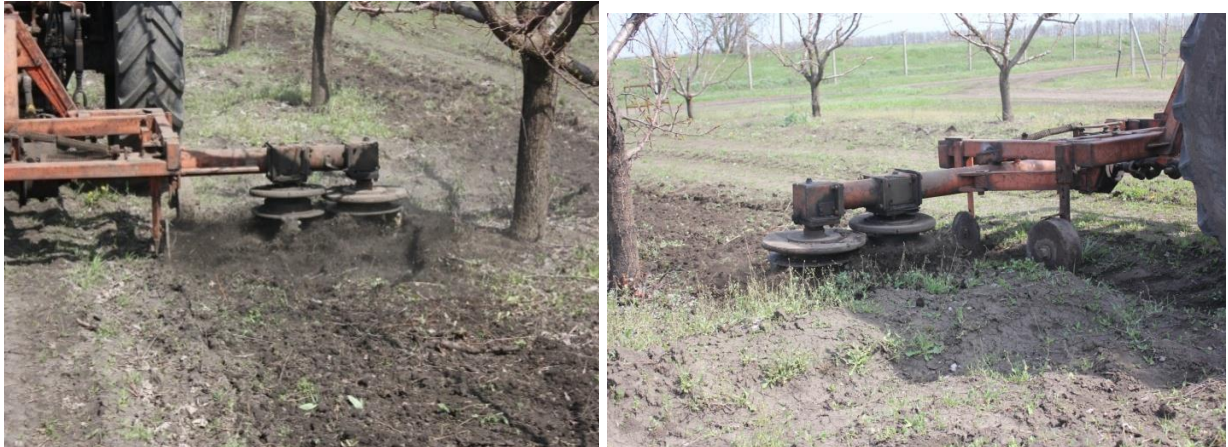
Рис.4.4. Обробіток ґрунту в пристовбурній смузі фрезерною машиною МФ-1М з експериментальними робочими органами.
