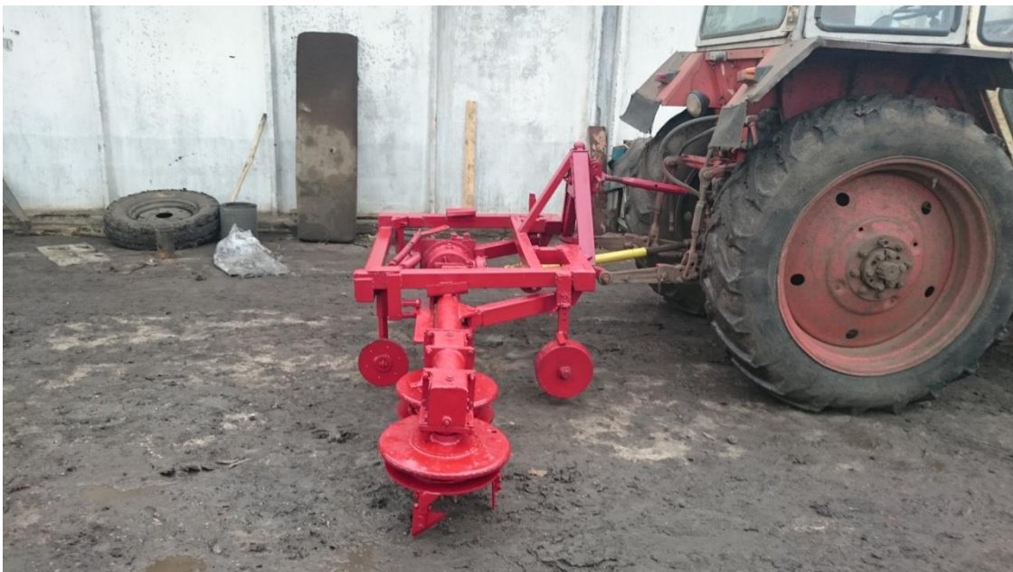
Рис.3.10. Загальний вигляд експериментального зразка фрезерної машини МФ-1М з трактором ЮМЗ-6.
