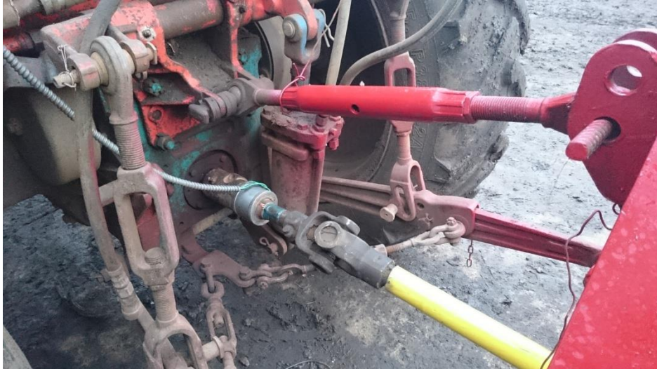
Рис. 3.13. Приєднання вимірювача крутного моменту на ВВП трактора.
