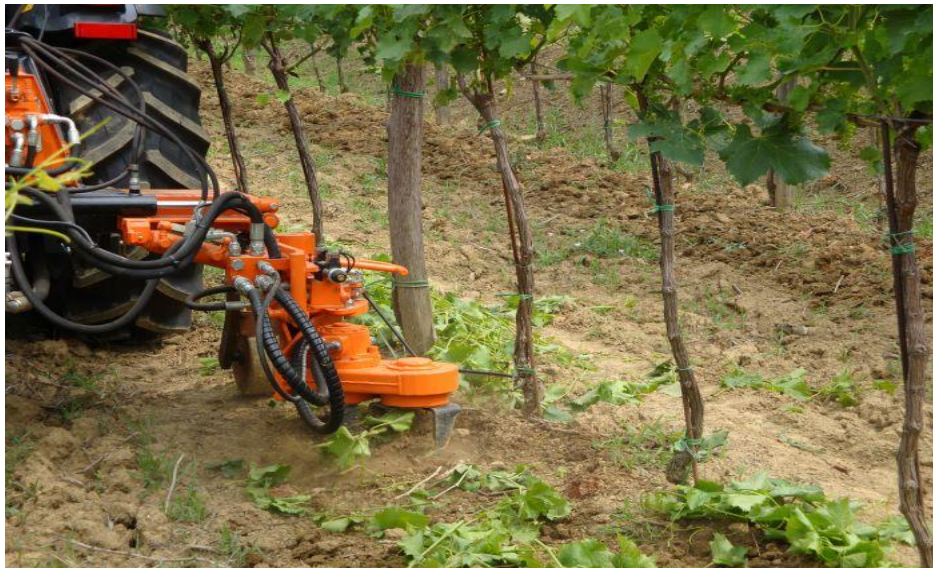
Рис.1.25. Фреза VELOX італійської фірми «RINIERI» обробляє пристовбурні смуги в плодкових насадженнях.
