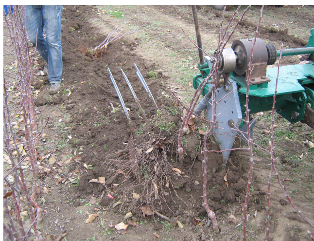
Рис. 3.5. Викопування саджанців сорту Ред Чиф експериментальним зразком робочого органу плуга ВПН - 2М.
