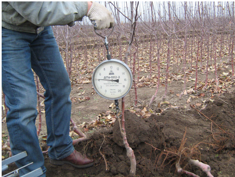
Рис. 3.6. Вимірювання зусилля на витягування саджанців динамометром ДПУ - 0,01-2.
