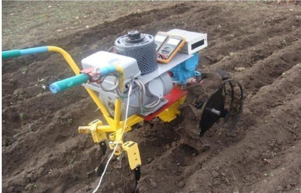
**Ефект від застосування:** зменшення питомих енерговитрат на 12-15% при виконанні основних сільськогосподарських процесів, пов'язаних з обробіткою ґрунту у порівнянні з мотоблоками з приводом від двигунів внутрішнього згоряння.
