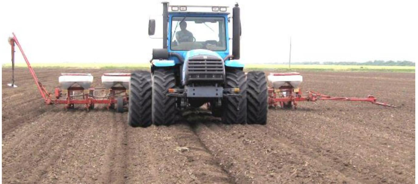
Вказаний колісний енергетичний засіб обладнаний подвоєними штатними шинами, тиск повітря в яких знижується до 0,7...0,8 мПа. Крім забезпечення нормального заглиблення сошників сівалки у ґрунт по слідах коліс трактора подвоєння шин суттєво зменшує ущільнення ґрунту і буксування рушіїв, сприяє підвищенню швидкості робочого руху і зменшенню питомих (погектарних) витрат палива.
