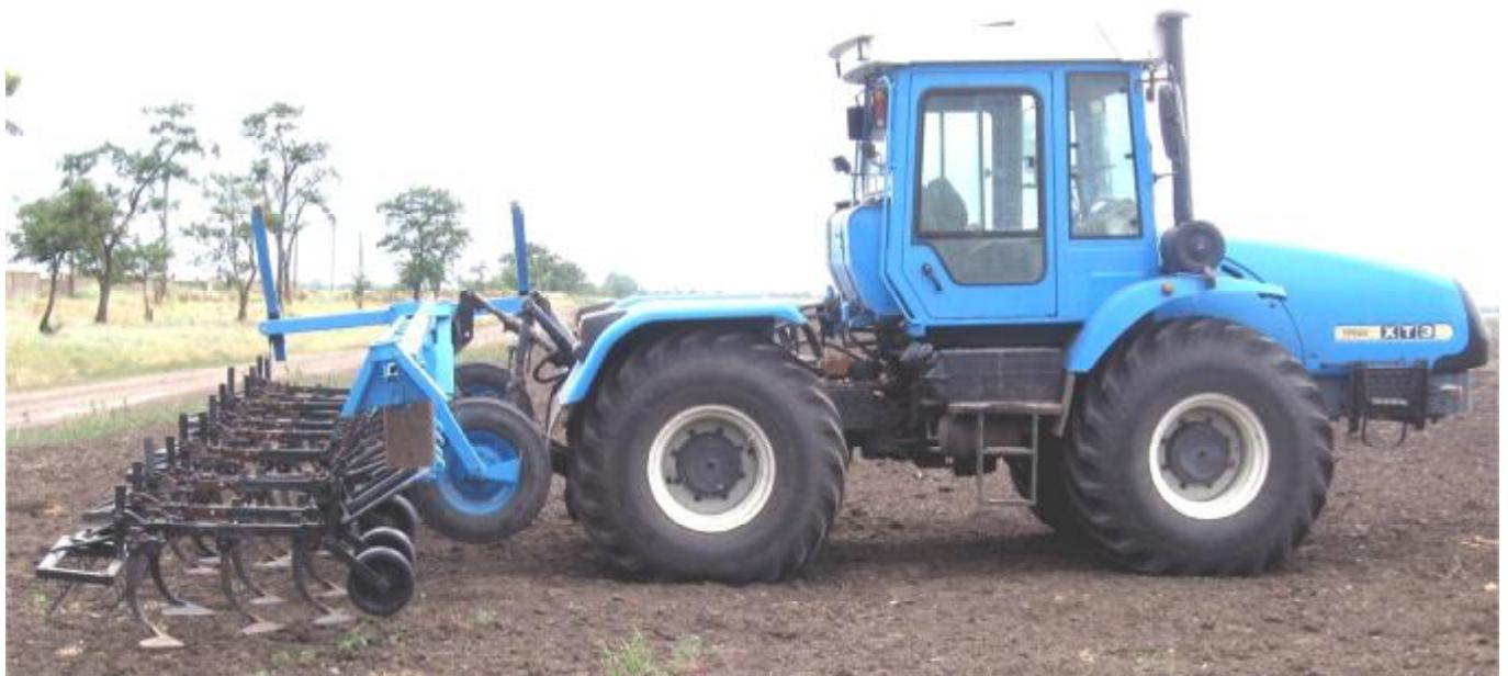
Застосування модернізованого культиватора замість двох знарядь типу КПС-4 та зчіпки дозволяє зменшити металоємкість агрегату на 30%.
