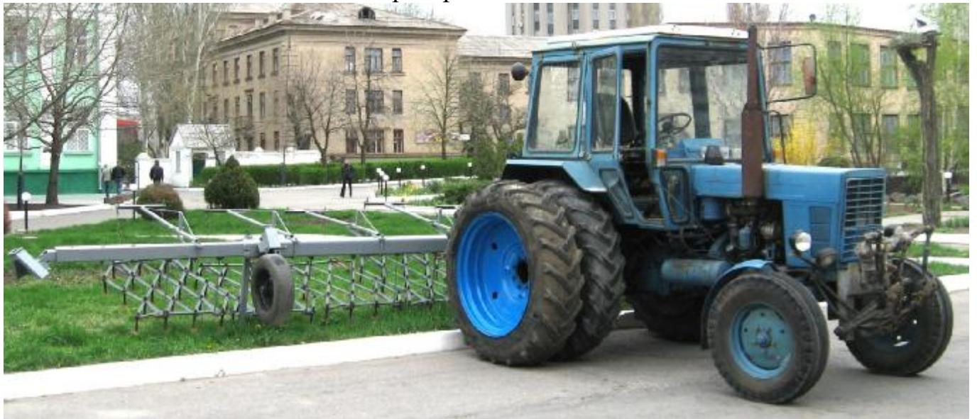
Конструктивна ширина захвату МТА становить 8,6 м. Висота установки рами борону вальної секції регулюється ступінчасто за рахунок переустановлення її транспортно-опорних коліс.
