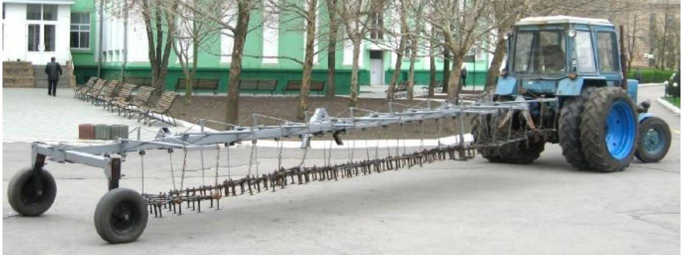
Боронувальна секція складається із рами, 9 борін типу БЗТС-1,0 та колісного ходу. Зуб кожної борони обладнаний робочим органом у вигляді трикутної пластини. Для транспортування на далеку відстань борону вальна секція обладнана власним зчіпним напівавтоматичним пристроям.
