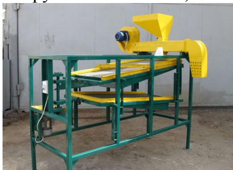
Рисунок 2 – Дослідно-промислова установка НВЧ знезараження комбікорму в псевдозрідженому шарі
