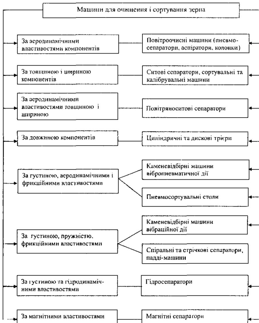
Рис. 3.1. Класифікація сепараторів зерна
