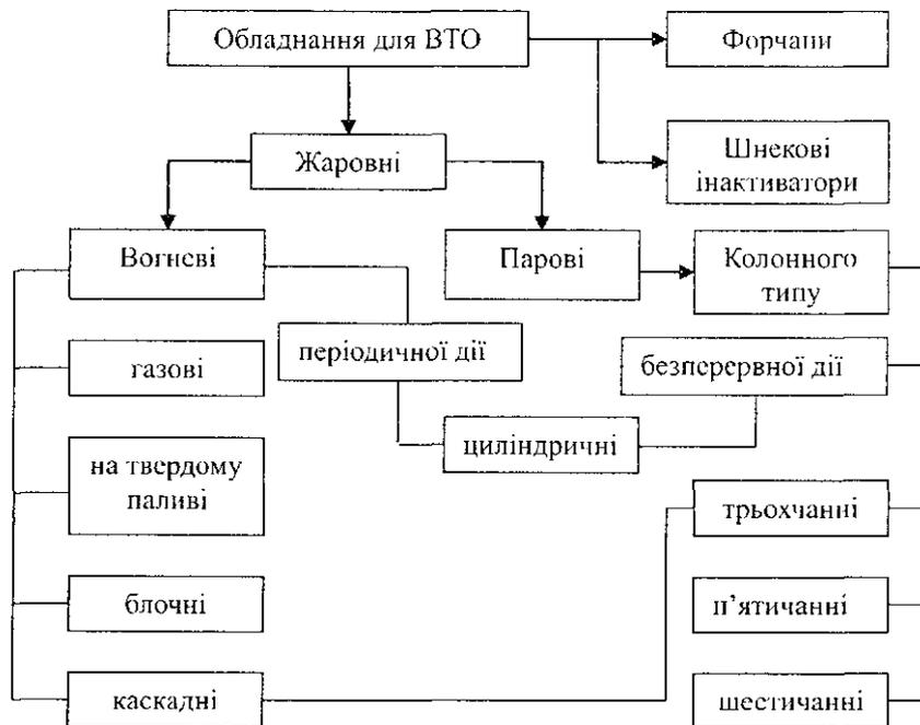
Рис. 3.50. Класифікація обладнання для волого-теплової обробки м'ятки
