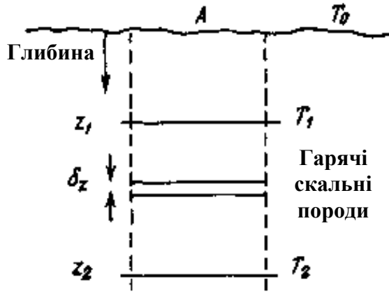
Рисунок 2 – Схема для розрахунку запасу тепла сухих гірських порід (щільність \rho_r , питома теплоємність c_r , температурний градієнт dT/dz=G ; A – площа; T_0 – поверхнева температура; T_1 – мінімальна корисна температура; T_2 – температура на максимальній глибині)
