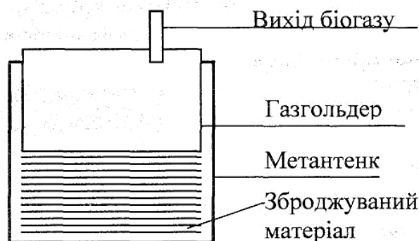
Рисунок 4.1 - Схема біогазової установки
