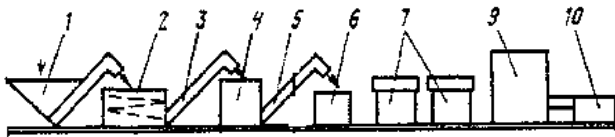
Рис. 4 Технологічна схема міні- маслоцеха: 1 - приймач-живильник; 2 - семенорушильная машина; 3 - гвинтовой конвеєр; 4 - чотирехвальцевый верстат; 5 - скребковий конвеєр; 6 - накопичувач; 7 - жаровня; 8 - шафа управління; 9 - прес гідравлічний; 10 - циклон.
