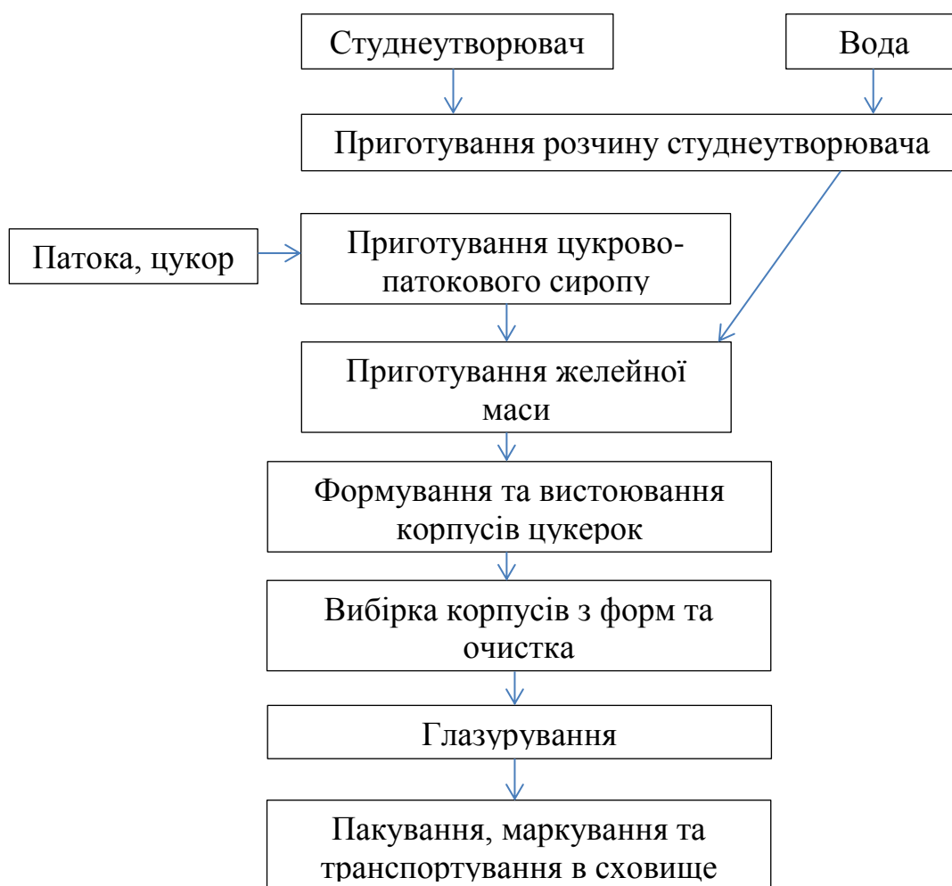
Рис. 1. Структурна схема процесу виробництва желейних цукерок
