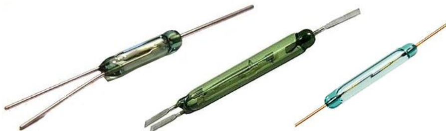
Рисунок 7 – Загальний вигляд герконів різних типів
