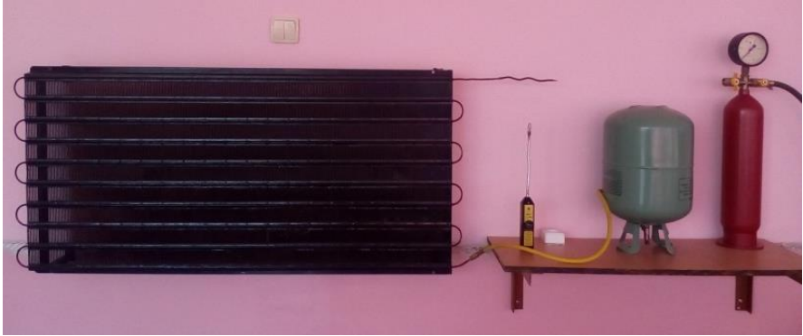
Рис. 3. Фотографія загального вигляду лабораторної установки для перевірки холодильного контура холодильної машини на відсутність витікання холодоагента за допомогою електронного галогенного течешукача WJL 6000.
