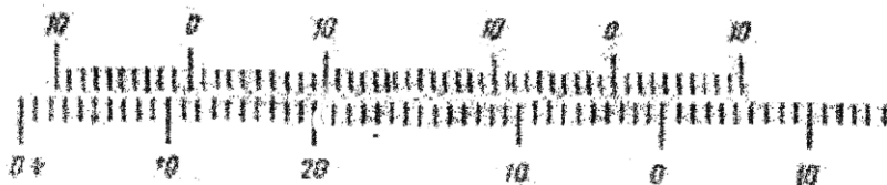
Рисунок 4 – Положення шкали і ноніуса, відповідне відліку 11,8^\circ
