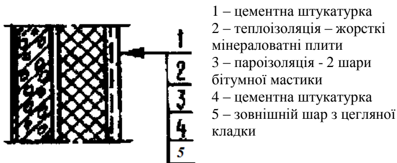
Рис. 4 Конструкція зовнішніх стін
