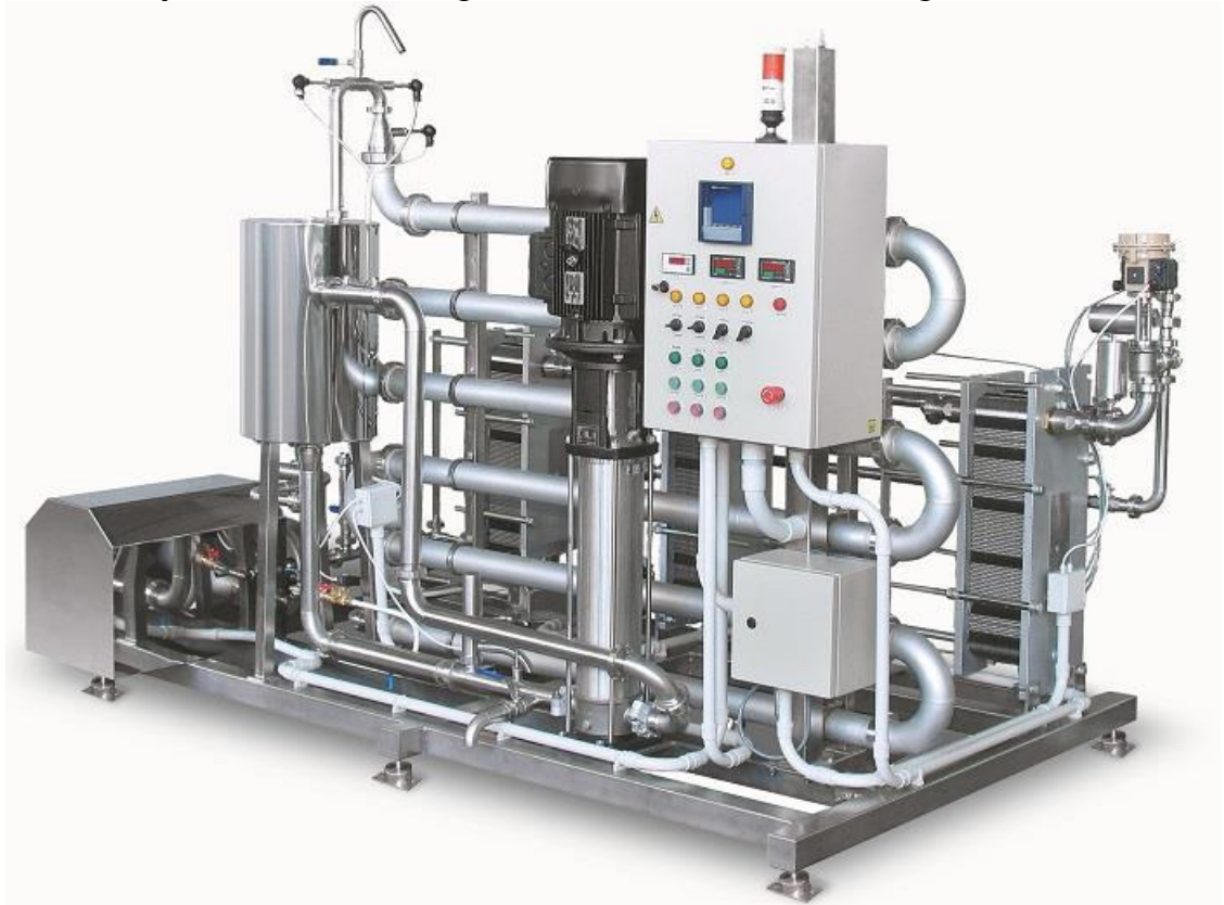
Рисунок 3.1 – Апарат для отримання ягідної пасту за HTD-Tehnology Переваги HTD-Tehnology
