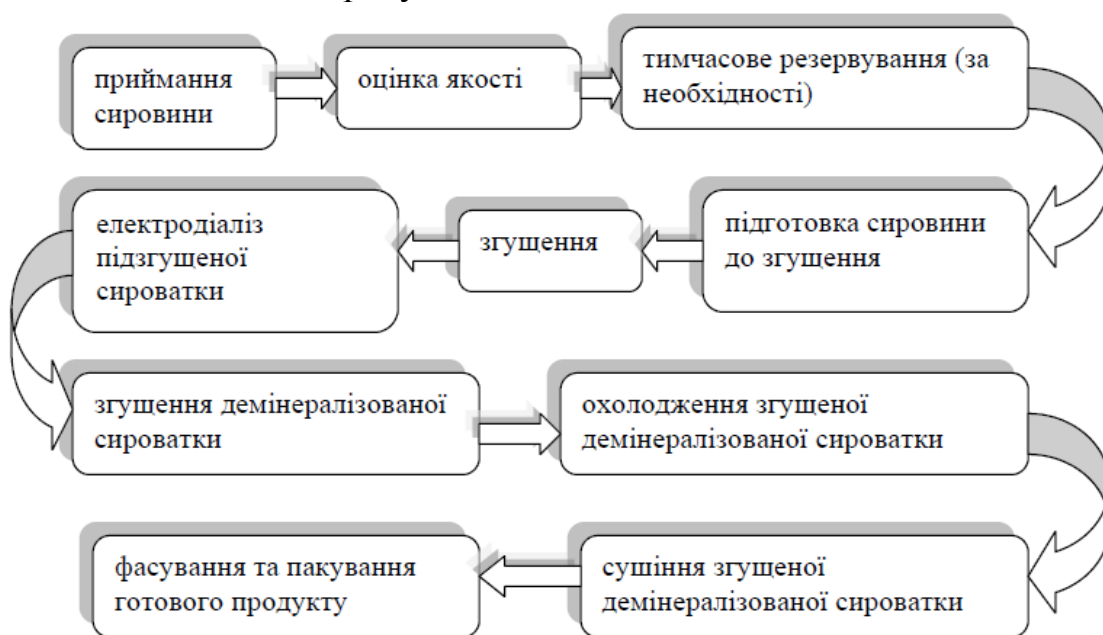
Рисунок 4.2 –Схема отримання демінералізованої сироватки
