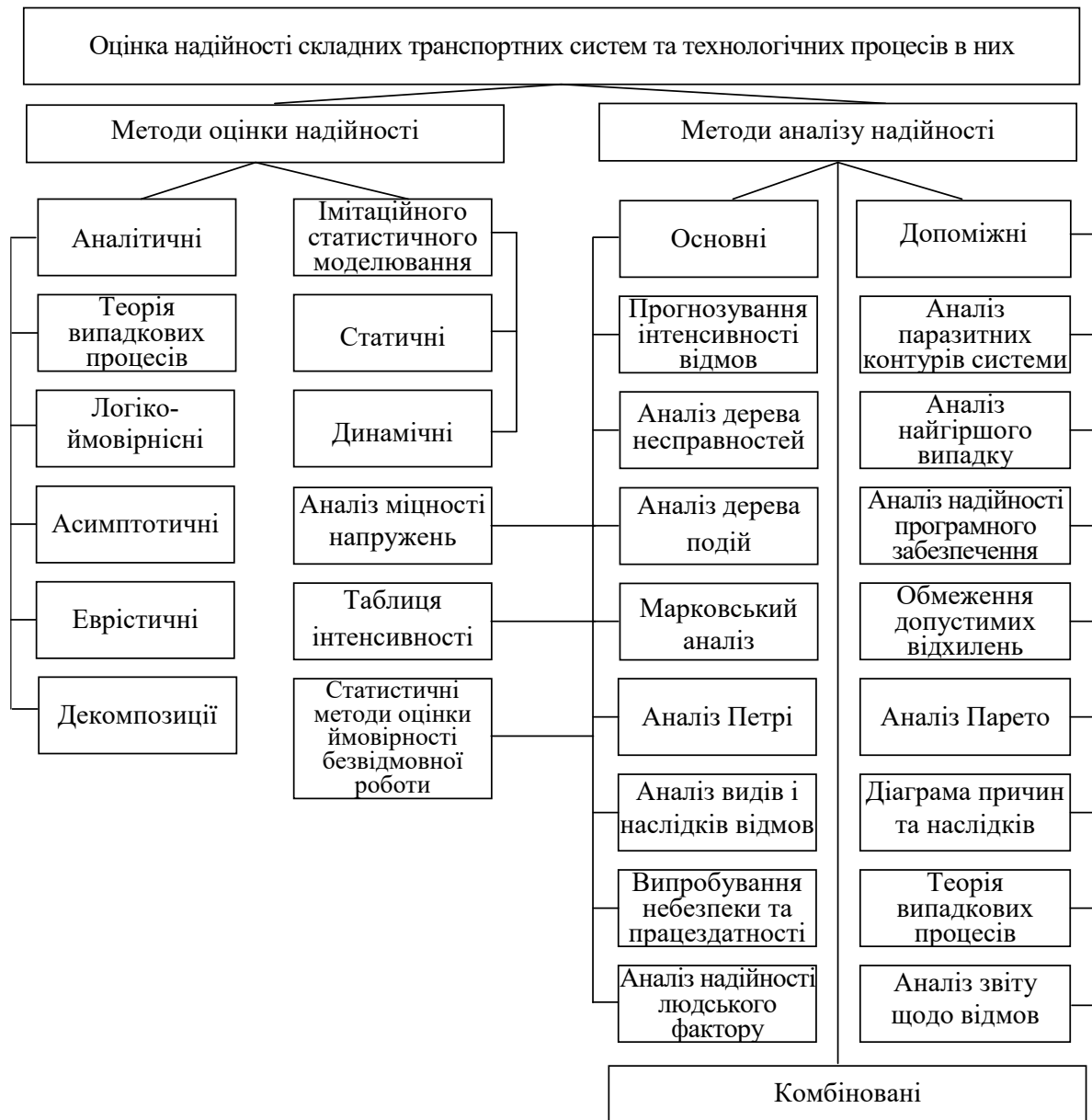
Рис. 1. Класифікація методів оцінки надійності складних транспортних систем і технологічних процесів в них.
