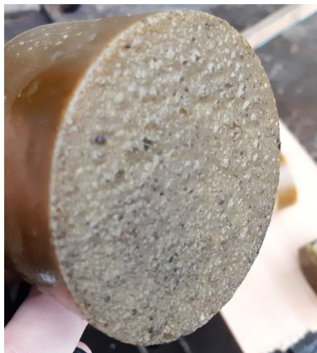
Рис. 6. Нижня частина твердого зразку воску після повільної кристалізації.
