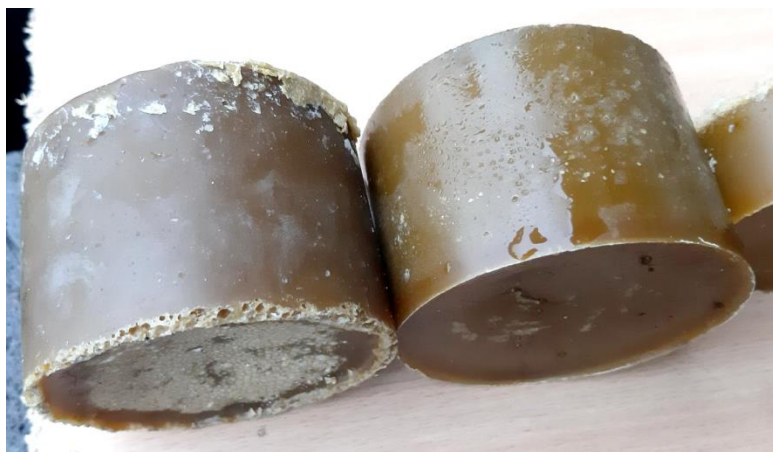
Рис. 5. Порівняння зразків воску після перетопки у воді (зліва) та після кристалізації (справа).
