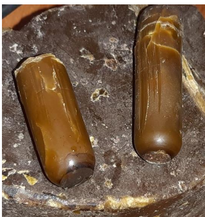
Рис. 2. Центрифугування: 10 хв (зліва), 6 хв (справа).
