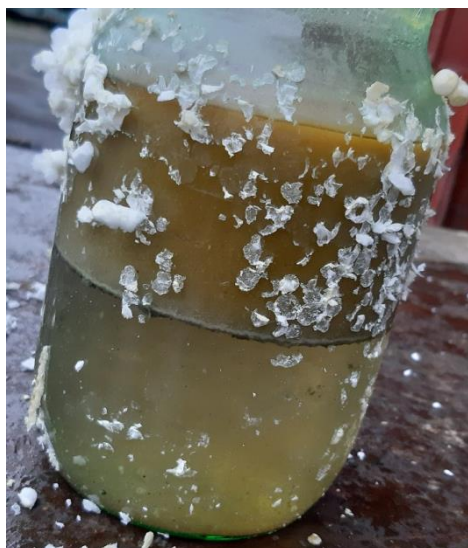
Рис. 6. Нижня частина твердого зразку воску після повільної кристалізації.
