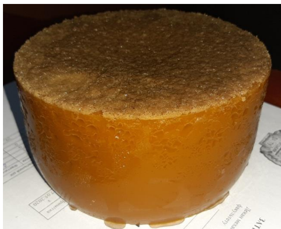
Рис. 10. Віск, очищений поступовою кристалізацією після проведення відстоювання на ТОВ «ВРМ-АГРО».
