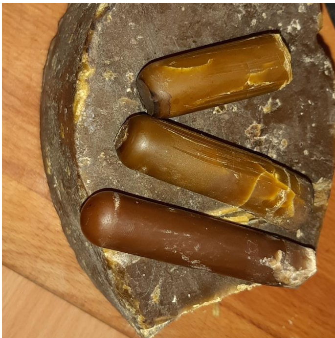
Рис. 1. Зразки продукції після центрифугування (відповідно зверху вниз): 6 хв, 3 хв і без центрифугування.
