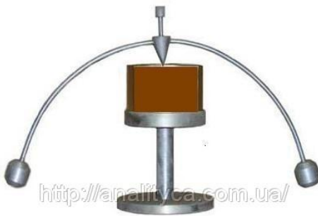
Рис. 2 – Конус Васильєва для вимірювання верхньої межі пластичності:
