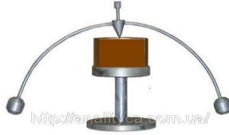
Рис. 2 – Конус Васильєва для вимірювання верхньої межі пластичності:
