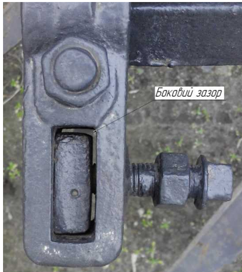
Рис. 1. Зазор між стійкою робочих органів та отвором тримача
