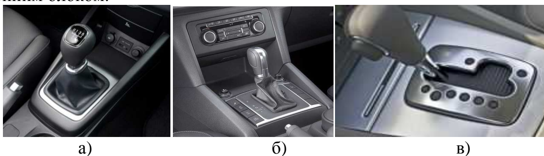
Рис. 1. Види коробок переміни передач: а) механічна; б) автомат; в) робот
