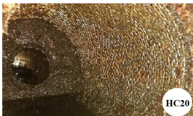
Рис. 3. Порівняння ступеня біообростання внутрішніх сіток фільтрів HC19 і HC20 (збільшений фрагмент)
