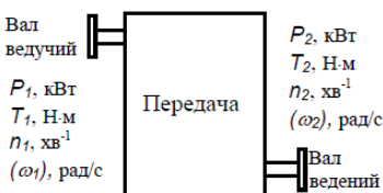
Рисунок 1 – Основні параметри передачі
