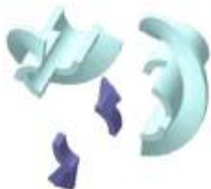
Рисунок 1 – Розподіл пінополістирольної моделі на частини
