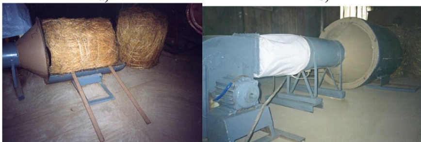
Рис.6 – Схеми сушіння рулонів із диференційованим підводом сушильного агента (а), (б) та загальний вигляд сушарки (в)
