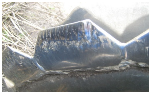
Рис. 1 Електроерозійне покриття робочої поверхні важких дискових борін
