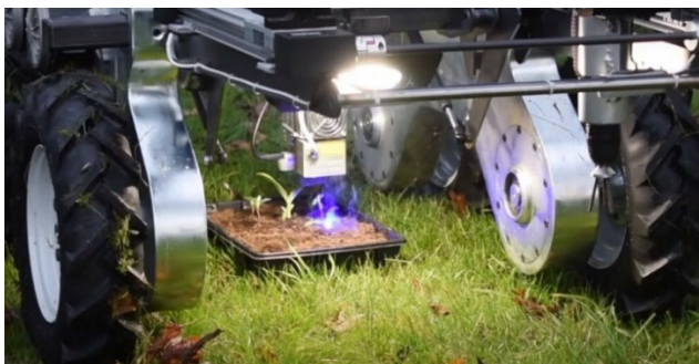
Рис. 2- Агробот Robi для знищення бур'янів
