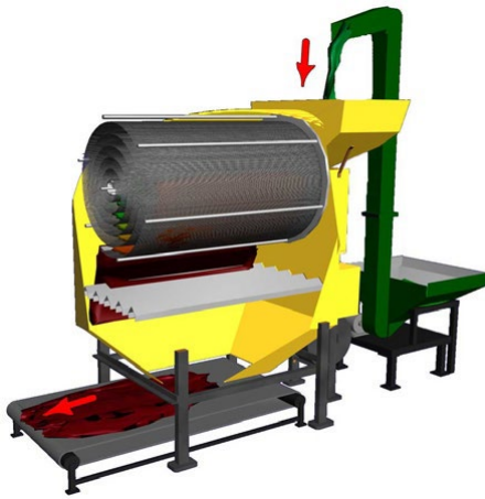
Рис.4 – 3-d моделі та схеми роботи сушарки сипких матеріалів з перемішуванням (а) та розпушування (б) шару матеріалу
