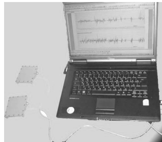
Рис. 1 – Вимірювальна система для визначення кінематичних і динамічних параметрів руху мобільних машин: а – структурна схема; б – загальний вид
