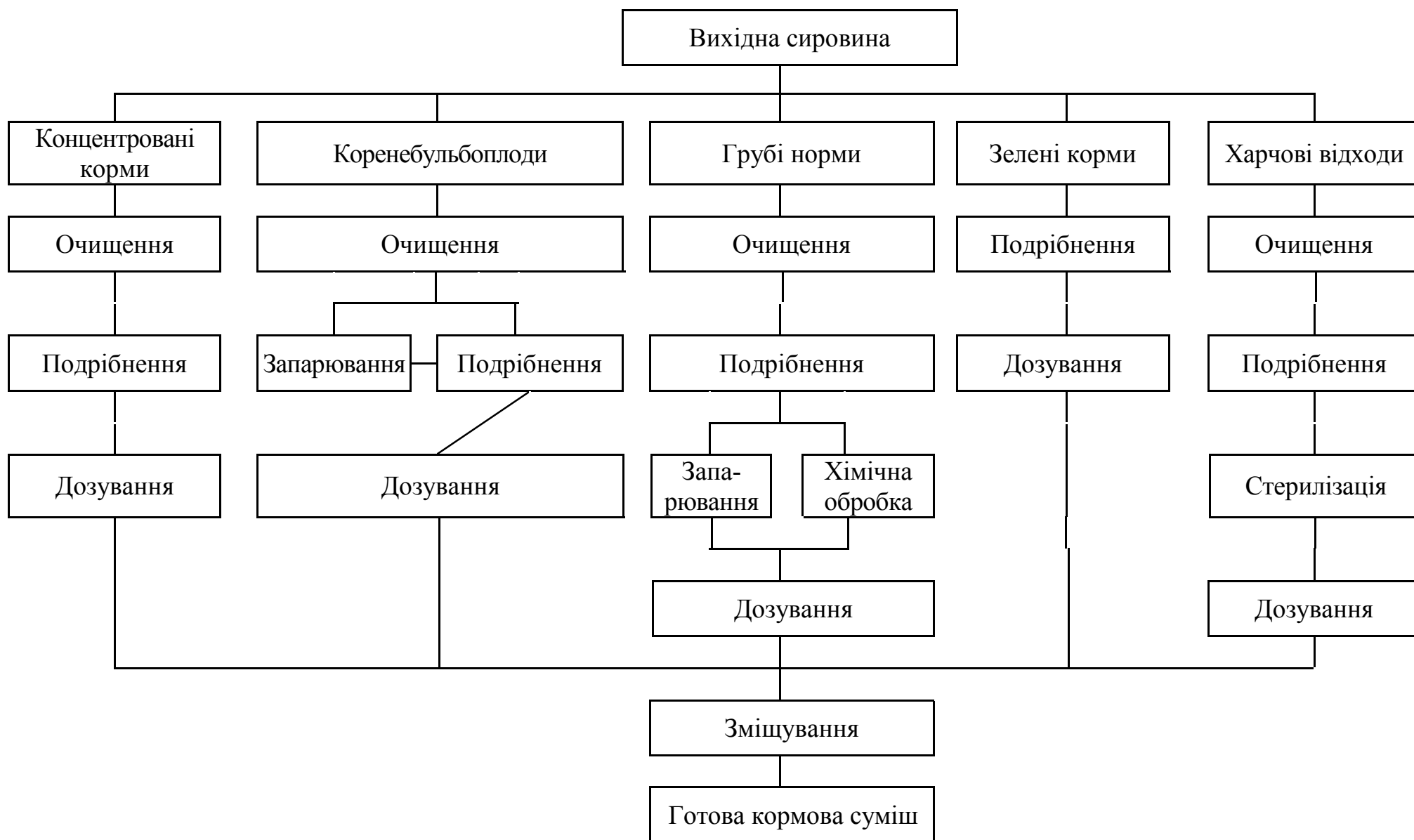
Рисунок 1 – Найпоширеніші технологічні схеми підготовки до згодовування основних кормових компонентів
