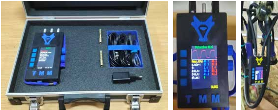
Рис. 1. Загальний вигляд тестера доїльних установок v.3.0
