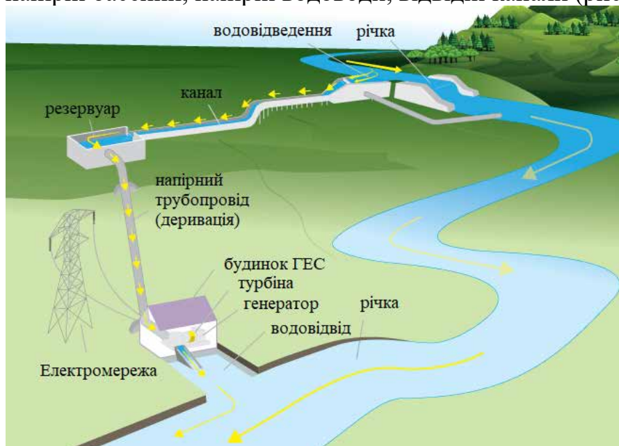
Рис. 1. Дериваційна схема створення напору на гідроелектростанції
